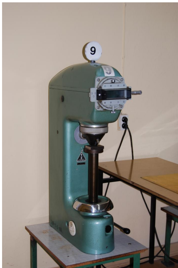
ĆWICZENIE NR 9. Próba twardości Brinella
